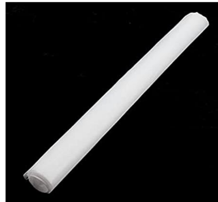
Fig. 3. Default reflectors for LaBr 3 :Ce (Teflon).
